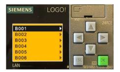
Wählen Sie mit den Tasten Pfeil nach oben und Pfeil nach unten den Parameter aus, den Sie ändern möchten, und drücken Sie die Taste OK. Ändern Sie den Wert wie gewünscht und drücken Sie die Taste ESC, um zum oben gezeigten Bild zurückzukehren.
